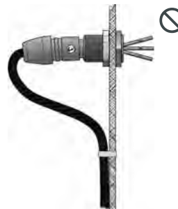
Entlastungsschleife – falsch Incorrect stress loop
