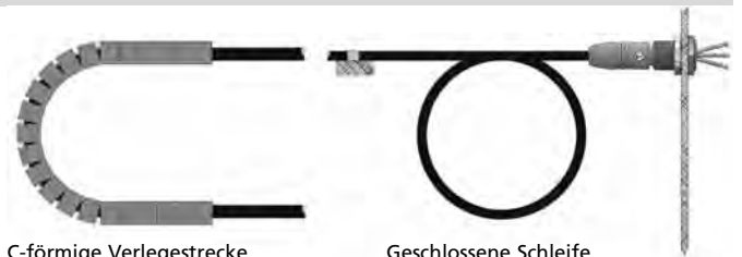
C-förmige Verlegestrecke (Schleppkette) C-Track
